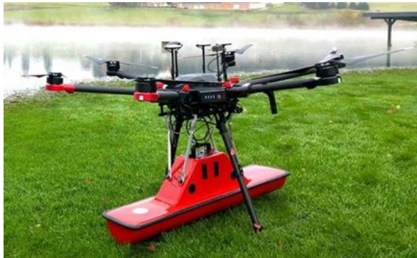
Фиг. 4. Мултикоптер и радар за проникване в земята (GPR) [1, 4]
