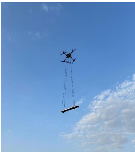
Фиг. 3. Мултикоптер, магнитометър MagArrow, GPR и реализирана траектория на полета [1, 6]
